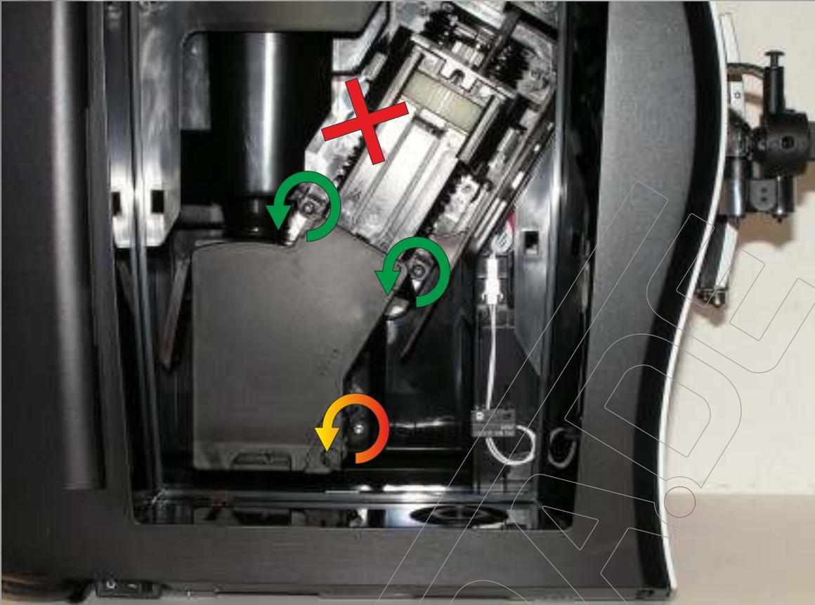
Diese 3 Schrauben mit einem Torx-Schraubendreher entfernen (andere sichtbare Schrauben bleiben montiert). Achtung! die 2 Schrauben (grüne Markierung) gesondert aufbewahren (metrisches Gewinde).
