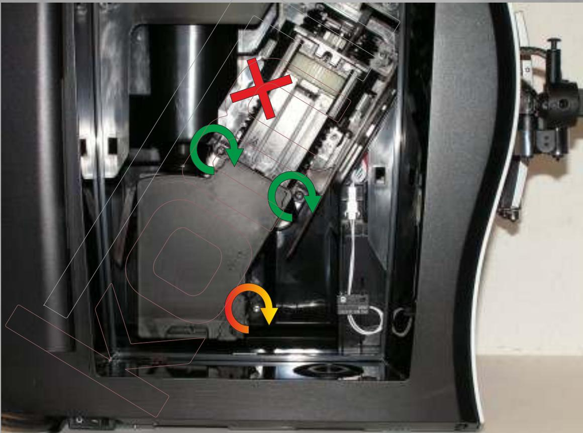
Diese 3 Schrauben wieder mit einem Torx-Schraubendreher eindrehen. Darauf achten, dass die 2 Schrauben (grüne Markierung) ein metrisches Gewinde haben! Nicht mit den übrigen Schrauben verwechseln.
