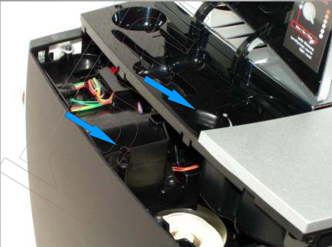
Beim anschließenden Aufsetzen des Deckels, darauf achten dass der Einsteller des Mahlwerks in der richtigen Position ist.
