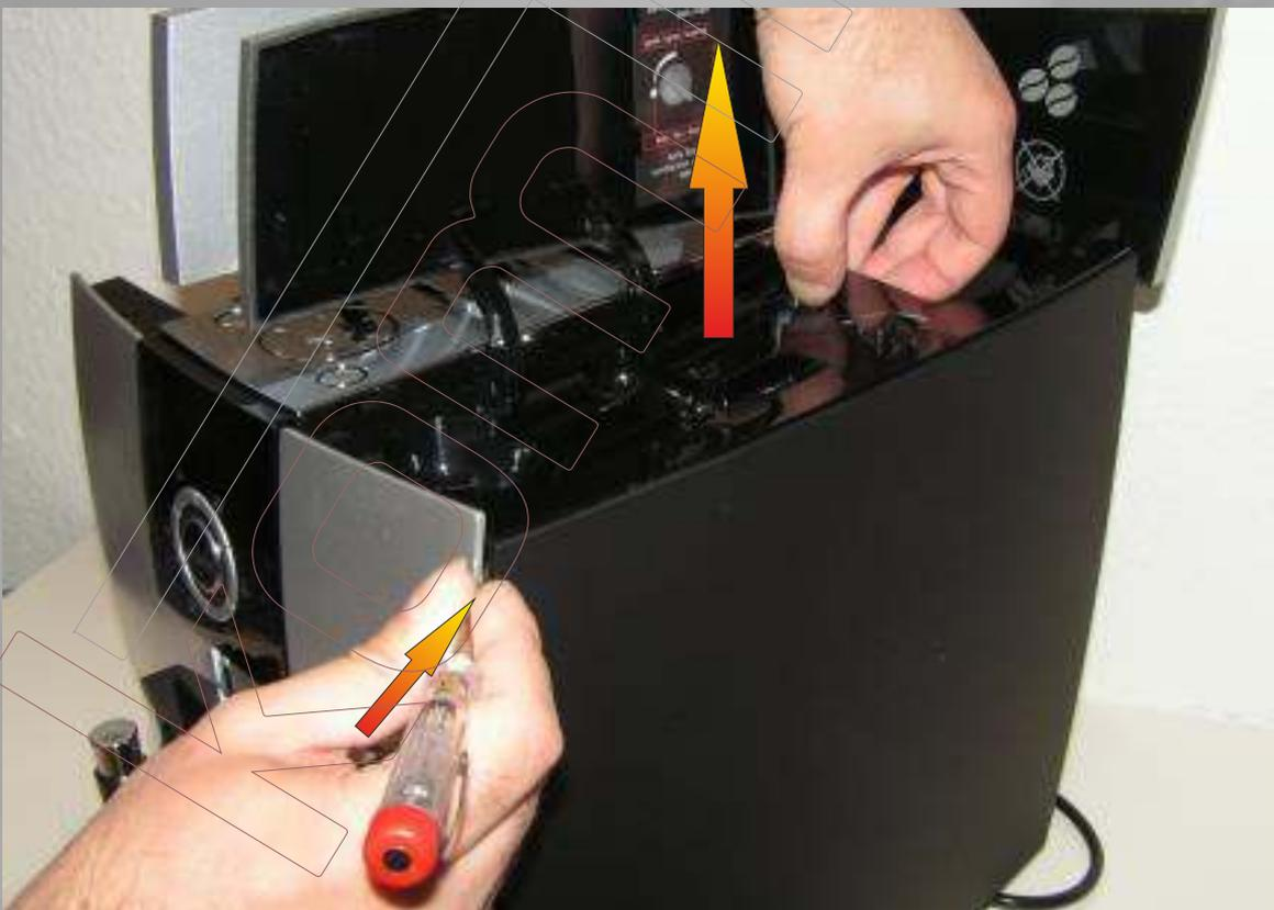
Wenn man SEHR VORSICHTIG ist, kann man am vorderen Spalt zwischen Front und Seitenwand mit einem kleinen Schraubenzieher nachhelfen. ACHTUNG dabei kann man leicht sichtbare Gehäuseteile verkratzen oder beschädigen!
