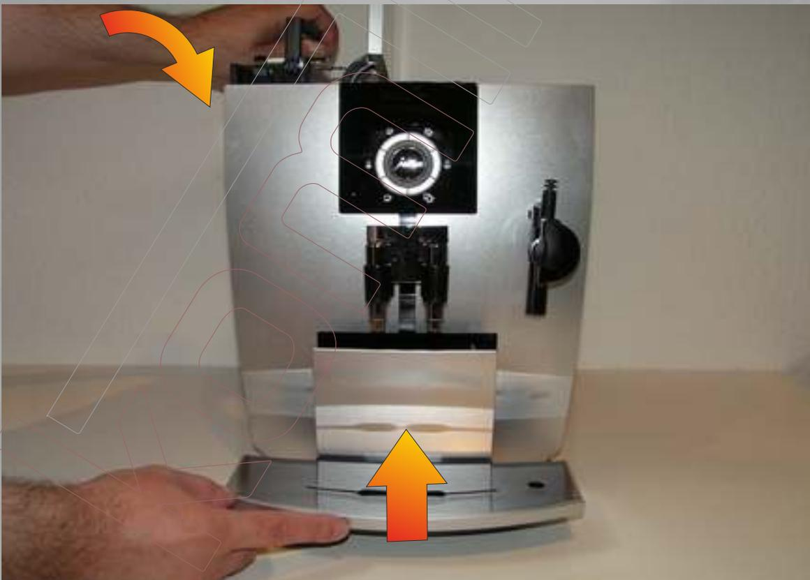
Wassertank, Tropfschale wieder einsetzen - Fertig!
