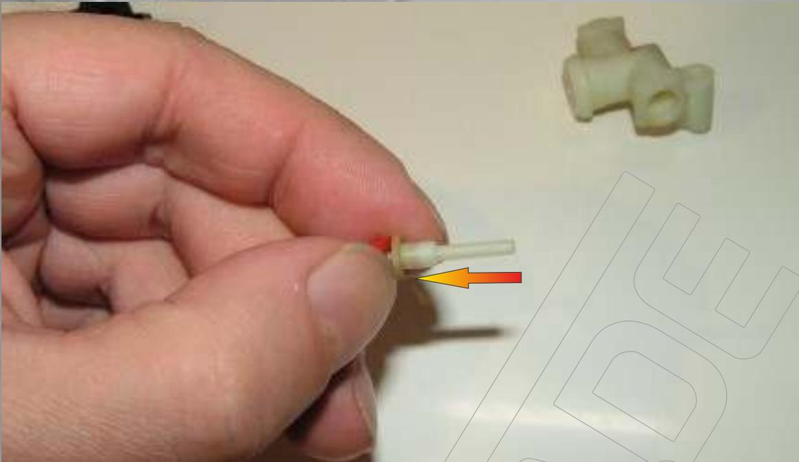
Zum Entfernen der Formdichtung z. B. einfach mit dem Fingernagel unter die Dichtung und sie dann abheben. Nachdem nun alles zerlegt ist, empfiehlt es sich alle Teile zu Entkalken und sorgfältig zu reinigen. Neben einer defekten Formdichtung sind Kalk und Schmutz die häufigsten Ursachen bei einer Fehlfunktion dieses Bauteiles.
