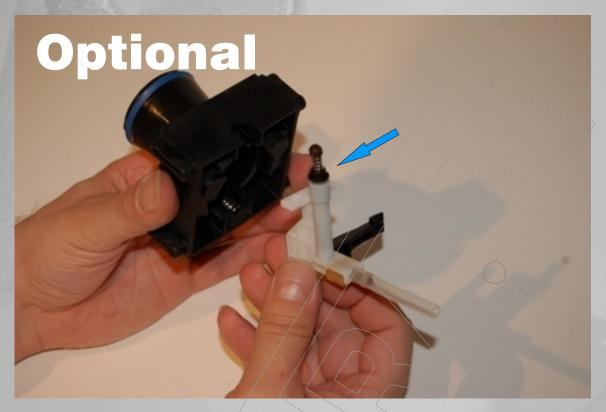
Cremaventil reinigen und Dichtung prüfen und gegebenenfalls ersetzen und das weiße Teil wieder mit den 2 Schrauben festschrauben.
