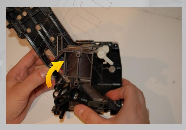
Unteren Kolben nach hinten schwenken.
