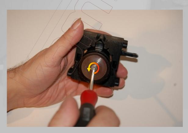
Brühsieb lösen und entfernen.
