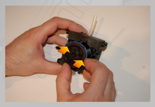
Dichtungsklemmring wieder aufsetzen.
