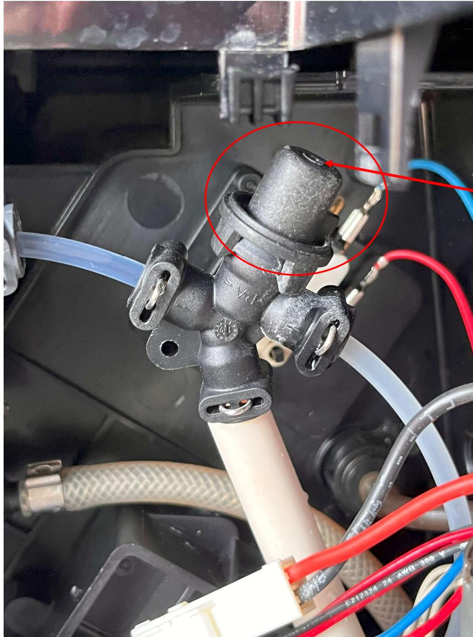
An dieser Stelle kommt Wasser raus und sammelt sich unter der Maschine. Es muss wohl ein Überdruck durch eine Blockade entstehen
